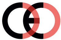
Virheellinen CE-merkki (liian lähellä)
